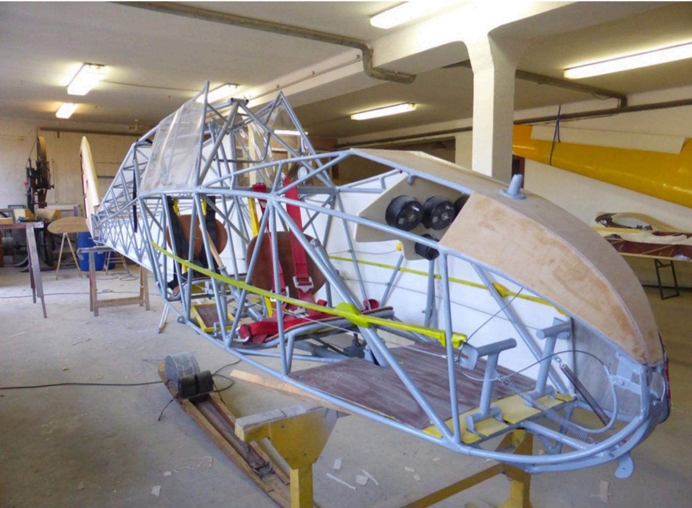
lackiert. Die Steuerseile, Kupplung, das Instrumenten-brett und Bugrad wurden komplett erneuert, die Kufe wieder hergestellt, und die Haube neu mit Plexiglas verkleidet.
