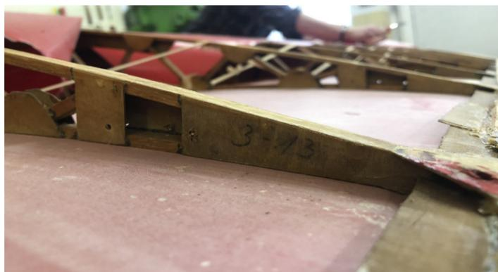
Seit März steht unsere Grunau Baby nun schon in der Werkstatt. In etlichen Arbeitsstunden wurde zunächst die alte Bespannung entfernt und alle Anbauteile demontiert. Im Anschluss wurde der alte Lack runter geschliffen.
